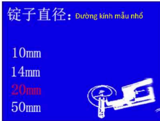
图 6-4 锭子设定界面 Ảnh 6-4 cài đặt mẫu nhỏ trên màn hình
